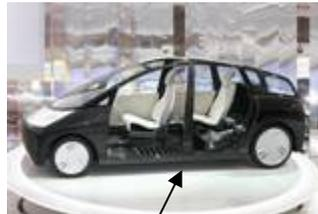
国産次世代軽量車体もCFRP
