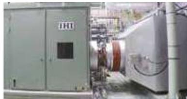
アンモニア混焼ガスタービン試験設備
