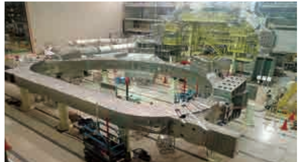
国際熱核融合実験炉 超電導コイル
