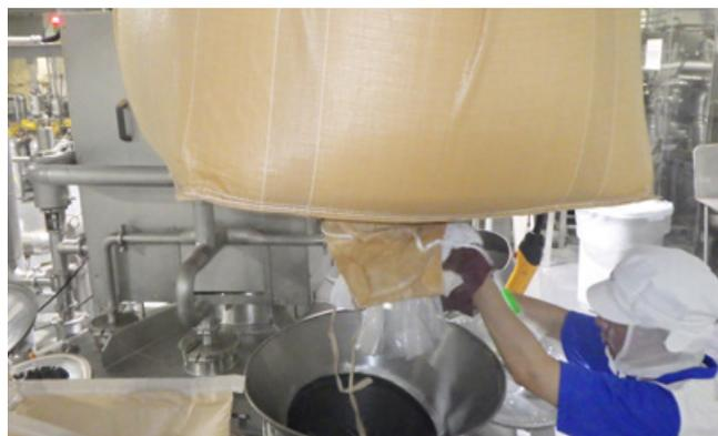
クレーンを用いフレキシブルコンテナバックから粉乳を投入する様子
