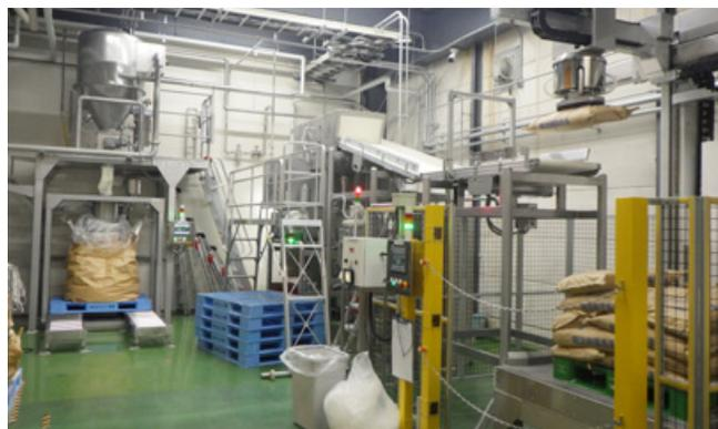
自動フレキシブルコンテナバック化装置
